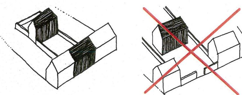
➤ Cas particulier de la parcelle à l'angle de 2 voies : le bâtiment a alors 2 façades principales et le pignon devient une façade exposée à la vue et doit être traité comme tel, soit en volume par l'ajout d'un volume de toiture soit en traitement de la façade par une composition spécifique
